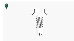
**Parafuso Autoperfurante:** Para fixar a calha aos postes e a chapa às calhas.
