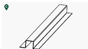
**Calha Ômega HLC:** Para fixação da chapa de vedação.
